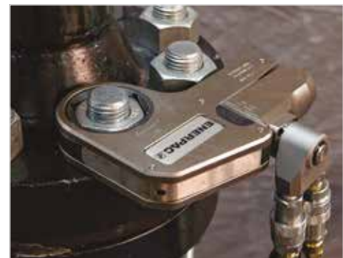
◀ Manutenção e montagem de guindaste com chave S1500X acionada por bomba de torque da série ZU4T.
