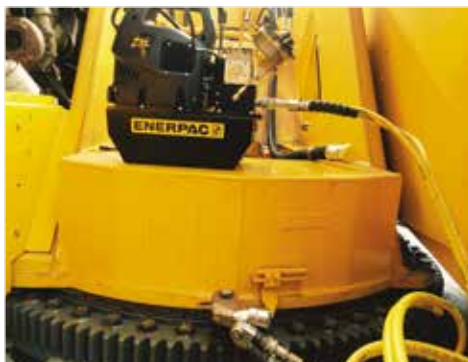
◀ Manutenção e montagem de guindaste com chave S1500X acionada por bomba de torque da série ZU4T.
