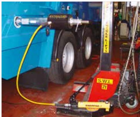
◀ Um RACH306, acionado por uma bomba manual P392, é usado para extrair pinos enferrujados de estrutura refugada em um veículo antigo.
