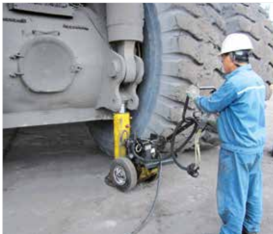
◀ POW'R-RISER® de Enerpac usado em operações de mineração para levantar equipamento pesado.
